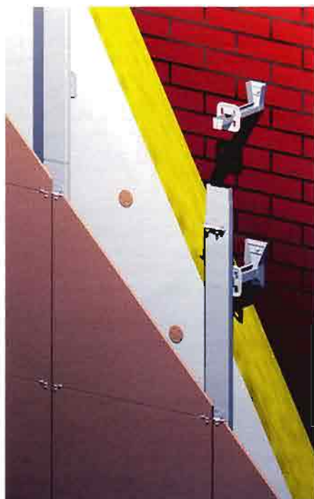
Система СА-01. Техническое свидетельство № ТС-07-1168-05. Навесная фасадная система с воздушным зазором для облицовки плитами из керамогранита с видимым креплением и утепления наружных стен зданий и сооружений различного назначения
